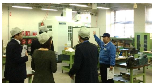
金属加工機械の説明を受ける参加者。機械で図面を読み取り自動で削りだすことができる。
