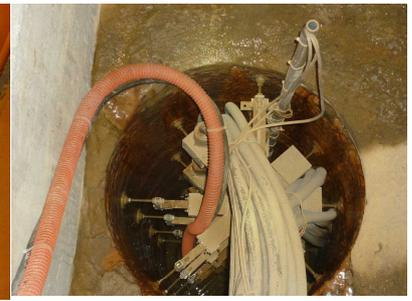
突っ張り棒のようなもので試験孔のひずみを計測している。
