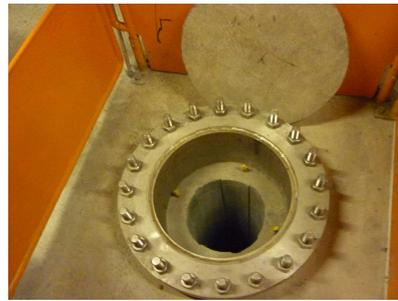
オーバーバック腐食試験孔。ここに緩衝材とオーバーバックが設置される。
